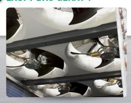
Alle Baugrößen der Baureihe **HPS** sind serienmäßig in schallgedämmter Ausführung "Low Noise" verfügbar. Durch Drehzahlregulierung der Ventilatoren, entkoppelten Rohren am Kältekreis, Einhausung der Verdichter und der Pumpen kann die Schallemission deutlich verringert werden.
